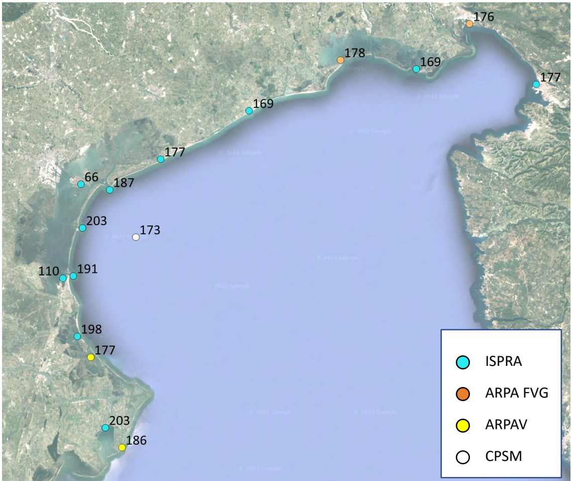
Figura 4: Livelli massimi raggiunti nel corso del 22 novembre 2022 presso le stazioni delle reti mareografiche di ISPRA (RMLV, RMN), ARPA FVG, ARPAV e CPSM.
